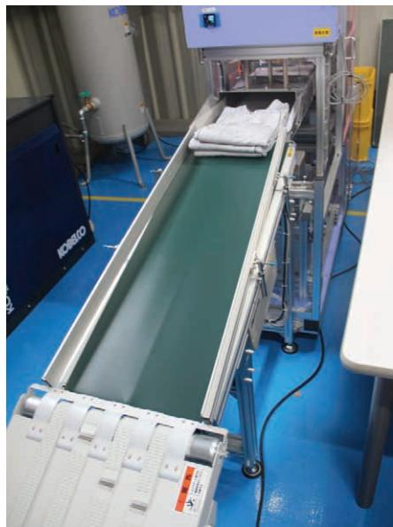
▲ ▲ 今年8月に増設した自動ライン。2台目となるトンネルフィニッシャーから出た品物は、ユラオーラフォルダーでたたまれ、コンベアでそのまま全自動包装機に投入される
