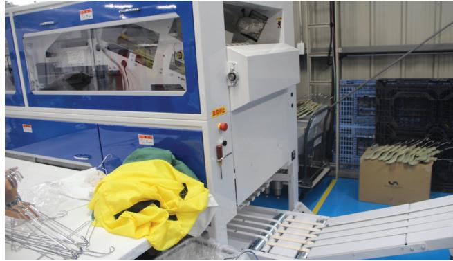
ネルフィニッシャーにユニフォームフォルダー、全自動包装機をつなげて、自動化ラインを組んだ。これにより、生産能力は8時間で16,000点にアップしている。
